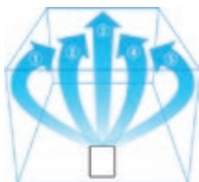
Vyhledává znečištěné oblasti a automaticky mění proudění vzduchu nastavením klapek doleva a doprava v 5 úhlech. Vytváří komfortní proud vzduchu v místnosti s rychlým odstraněním nečistot.
